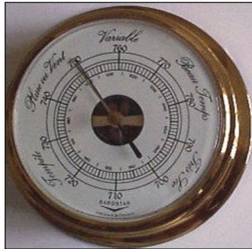
Le baromètre peut être utilisé dans une maison pour savoir le temps qu'il va faire ou pour savoir si le temps va changer beaucoup d'une journée à l'autre. L'unité de pression utilisée en météorologie est l'hectopascal. On utilise aussi le centimètre de mercure. On mesure la pression atmosphérique avec le baromètre.
